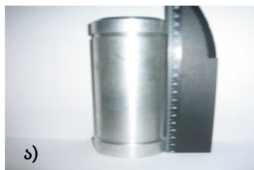
დამზადებული Al-(B 4 C+Pb)-ფოლადი. მრავალფენიანი კონტეინერის საჩვენებელი ნიმუში: ა) საერთო ხედი; ბ) თავსახური და კონტეინერის ტანი ცალ-ცალკე.
